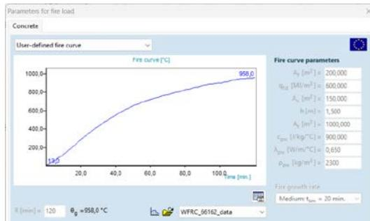
Curva di fuoco modificata degli idrocarburi per elementi in acciaio.
